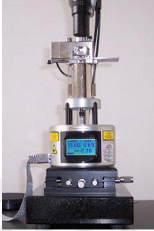
Şekil 3.4. PHEMAC-Cu +2 ve PHEMAC Biyosensörlerin yüzey karakterizasyonu için kullanılan Atomik Kuvvet Mikroskobu cihazının görüntüsü
