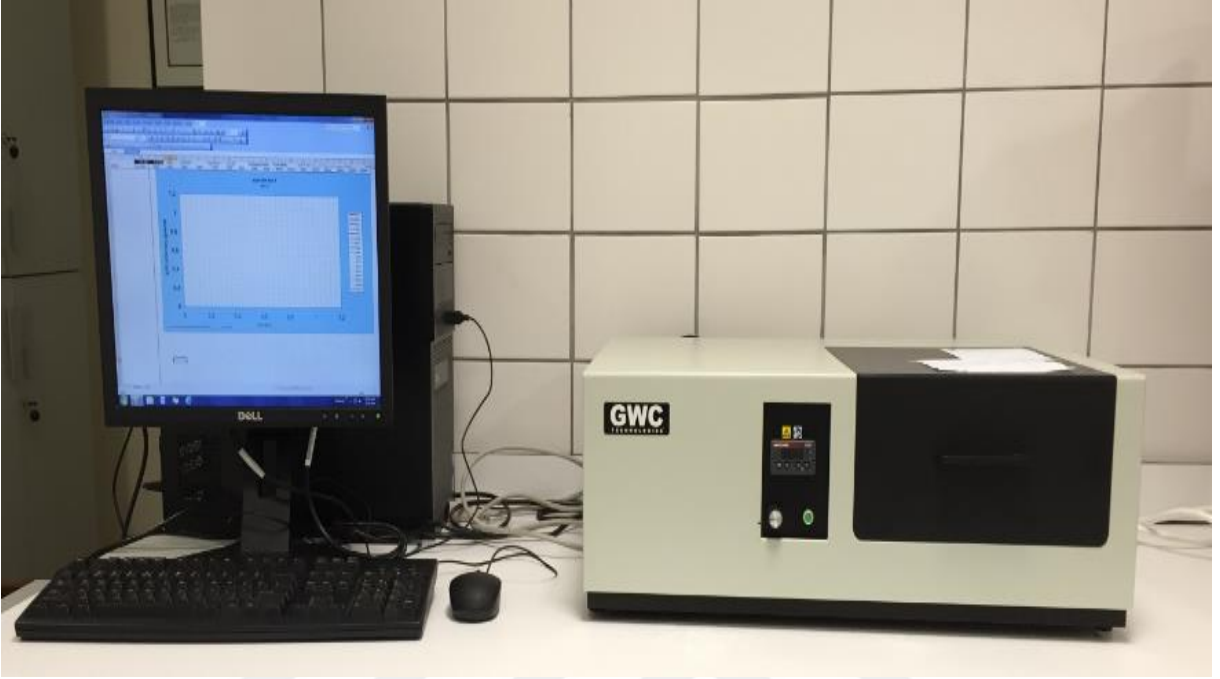
Şekil 3.7. PHEMAC-Cu +2 ve PHEMAC Biyosensörlerin kinetik analizlerinin yapıldığı SPR ölçüm cihazının görüntüsü.
