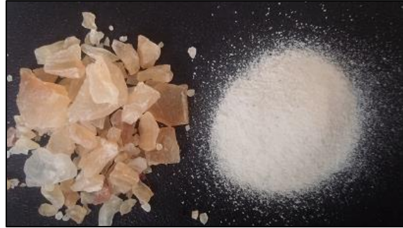
Şekil 3.1 Kitrenin taş formu ve öğütme sonrası tozu görüntüleri
