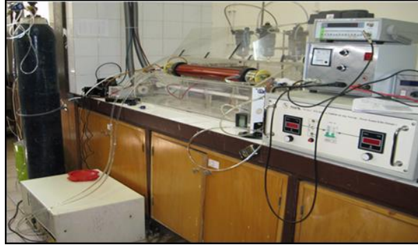
Şekil 3.2. Ozon gazı üretimi için tasarlanan deney düzeneği
