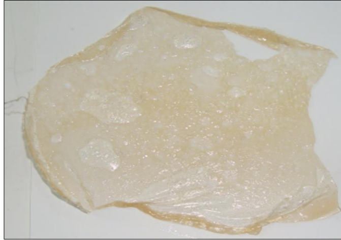
Şekil 4.2. Yüksek gliserol konsantrasyonu aralığında (% 4-8 v/v) hazırlanan yara örtü filmi görüntüsü
