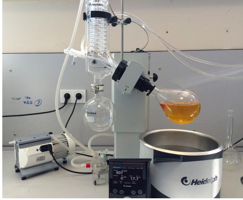
Şekil 4.2. Deneysel Çalışmalarda Toz Pigment Eldesinde Kullanılan Döner Buharlaştırıcı
