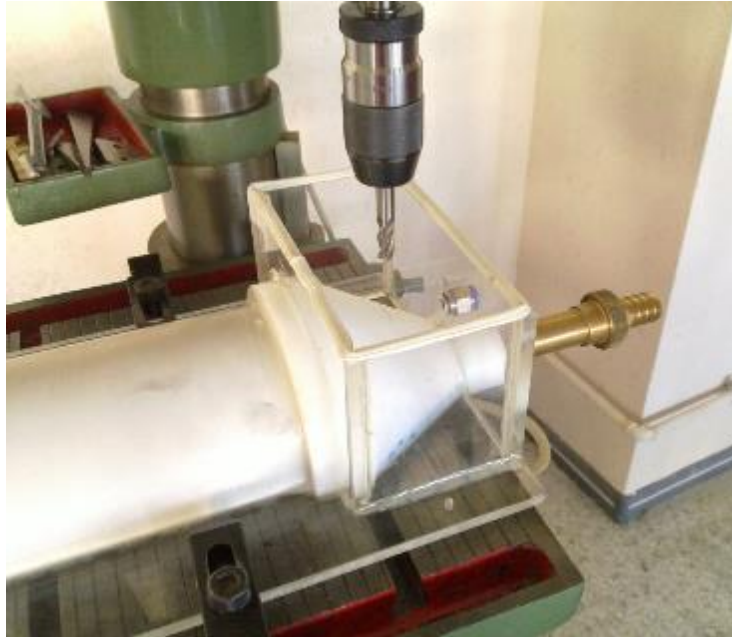
Şekil 2.10. Akışkanlaştırma gazının sisteme beslenmesi için tasarlanan gaz haznesi
