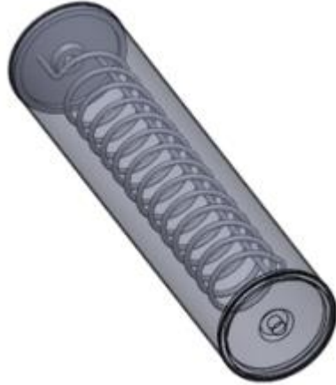
Şekil 3.8. Hava ısıtıcısı ve haznesi
