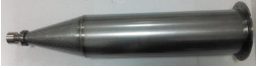
Şekil 3.2. Taşkın-akışkan yataklı kurutucunun konik ve silindirik kısımlarının üç boyutlu çizimi ve fotoğrafı.
