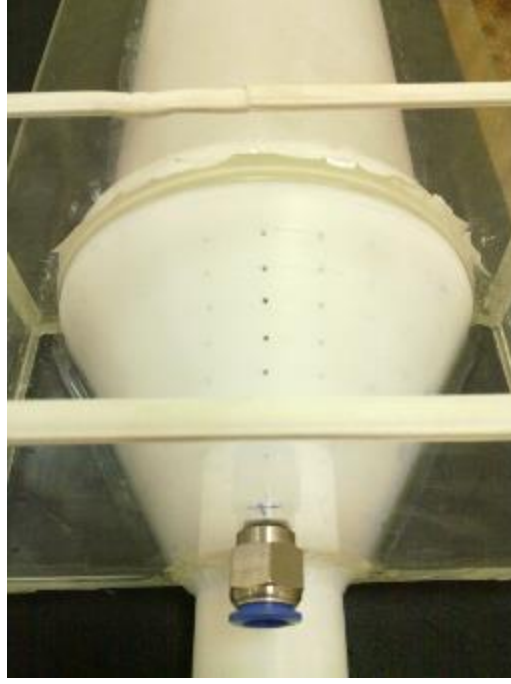
Şekil 2.9. Gaz dağıtıcı görevindeki delikli konik bölge duvarı
