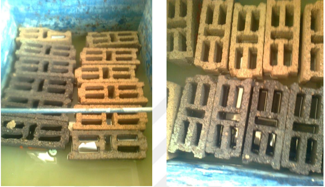
Şekil 3.3. Su havuzundaki sertleşmiş beton örnekleri
