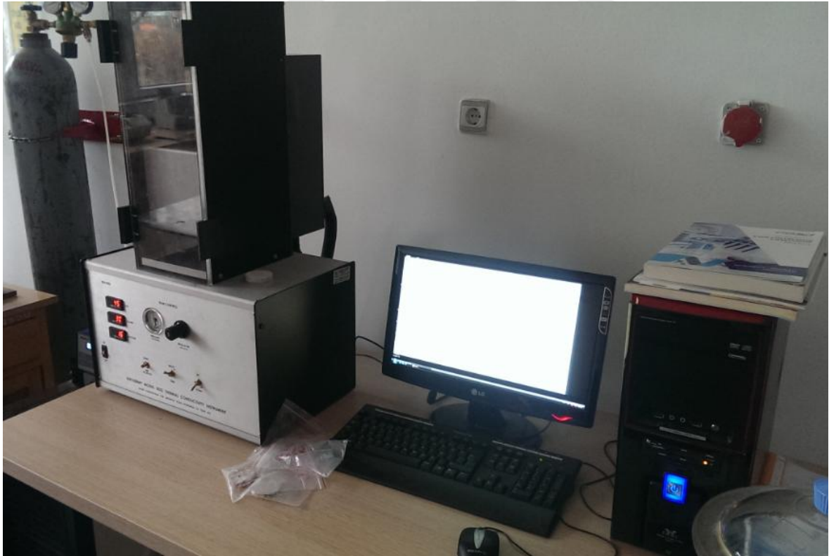
Şekil 3.6. Unitherm 2022 ısı iletkenlik katsayısı ölçüm cihazı
