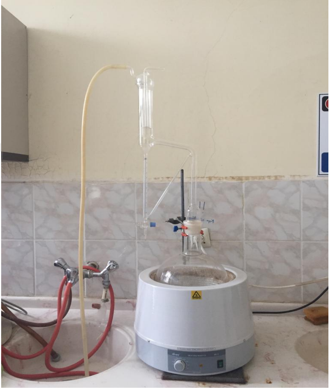
Şekil 3.11. Uçucu yağların elde edildiği Clevenger düzeneği
