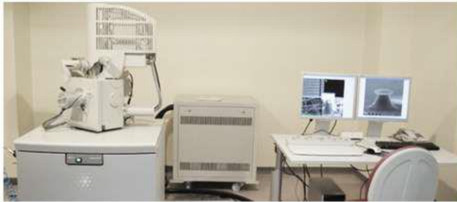
Şekil 3.6. MPBA bađlı-poli(POSS-MA) ve VPBA bađlı-poli(POSS-MA) monolitik kapiler kolonların karakterizasyonunda kullanılan taramalı elektron mikroskobu, Quanta 200 FEG SEM cihazı [9].
