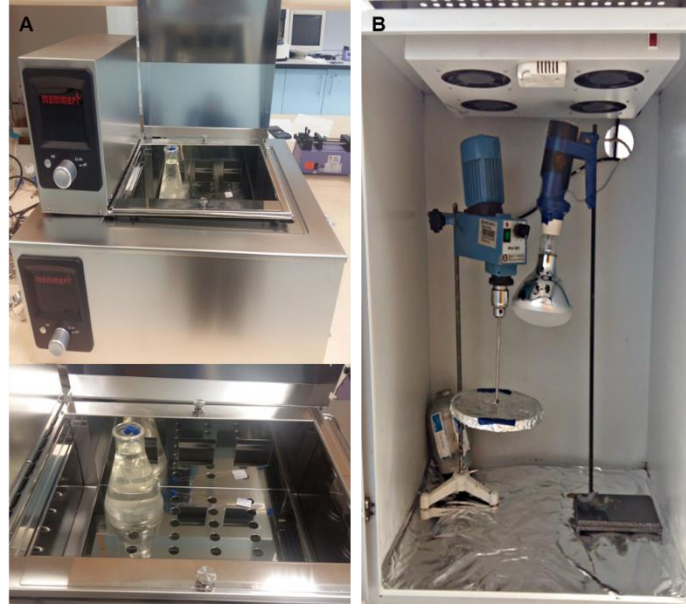
Şekil 3.3. Polimerizasyon sistemleri. (A) VPBA bağlı-poli(POSS-MA) monolitik kolonların su banyosunda polimerizasyonu. (B) MPBA bağlı-poli(POSS-MA) monolitik kolonun UV-ışını altında polimerizasyonu.
