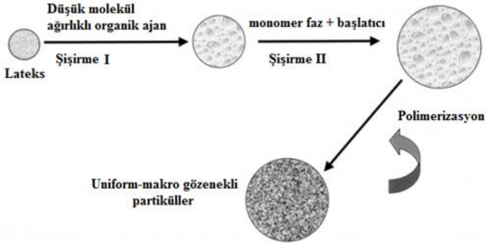
Şekil 2.6 Çok basamaklı mikrosüspansiyon polimerizasyonunun şematik gösterimi [47]
