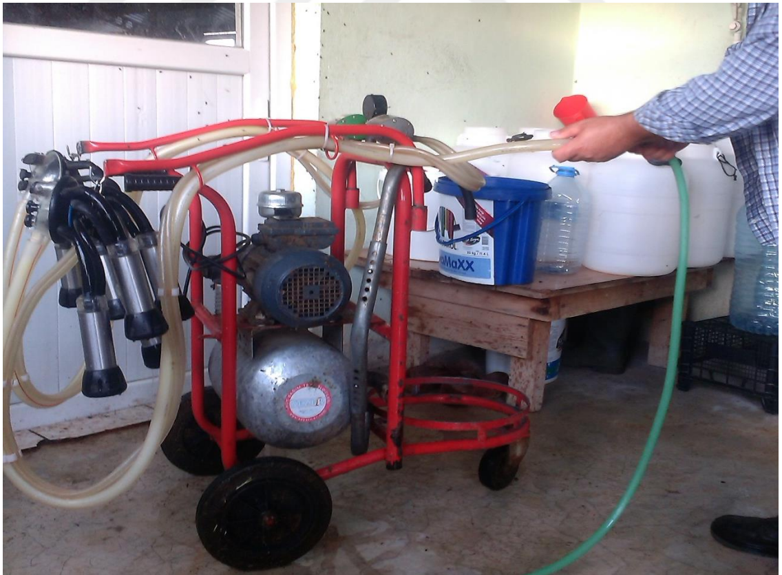
Şekil 4.47. Merkeze bağlı Oğlaktepe köyündeki bir işletmede sağım sonrası makinenin temizlenmesi
