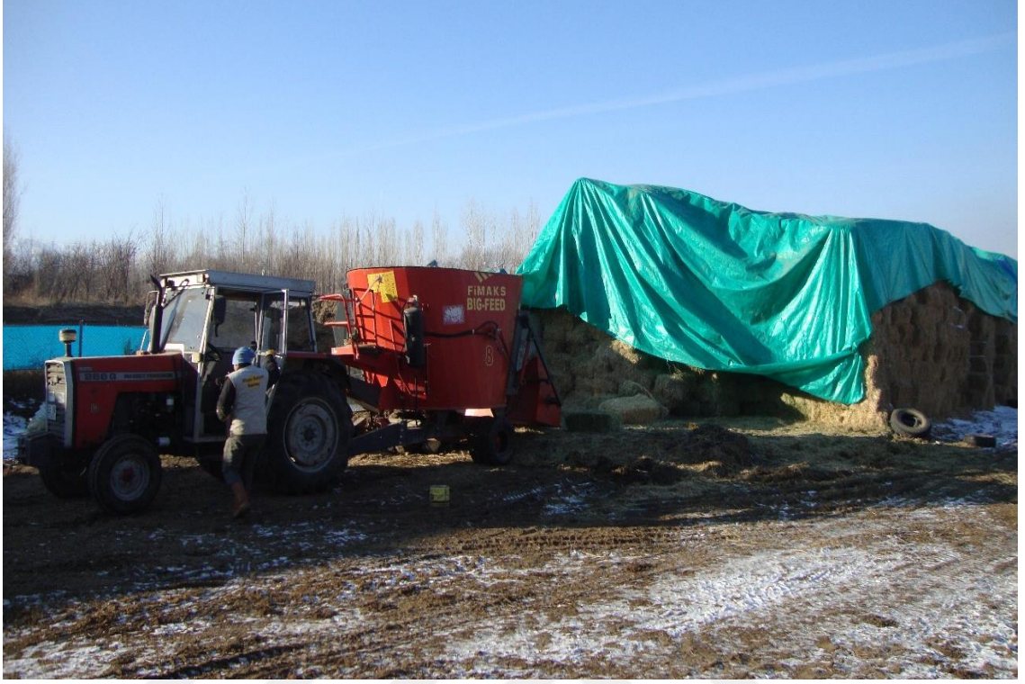
Şekil 4.39. Modern bir işletmeye ait yem karma makinesi ve karıştırılan yemlerin dağıtılmak üzere traktöre bağlanması
