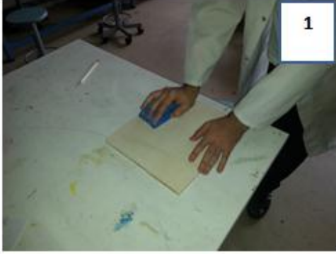
Ahşap plakayı zımpara ile düzeltiyoruz.
