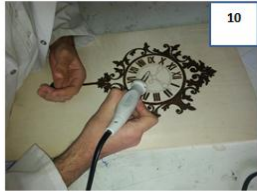
Makinenin yakma ucunu kalem gibi kullanıp resmin üzerinden geçiyoruz.
