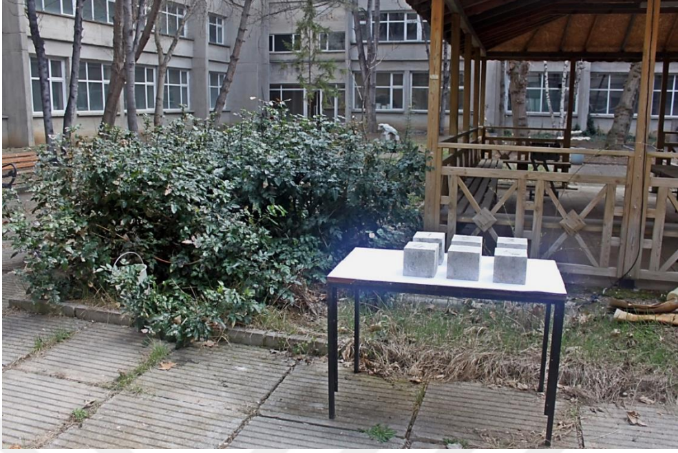
Şekil 6.8. Dış ortam deneyine maruz bırakılmış beton numunelerin genel görünümü (Hacettepe Üniversitesi Jeoloji Mühendisliği Bölümü orta bahçe)
