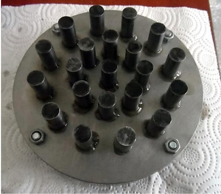
Şekil 5.16. Kalıba yük bindirme çubuklarının yerleştirilmesi
