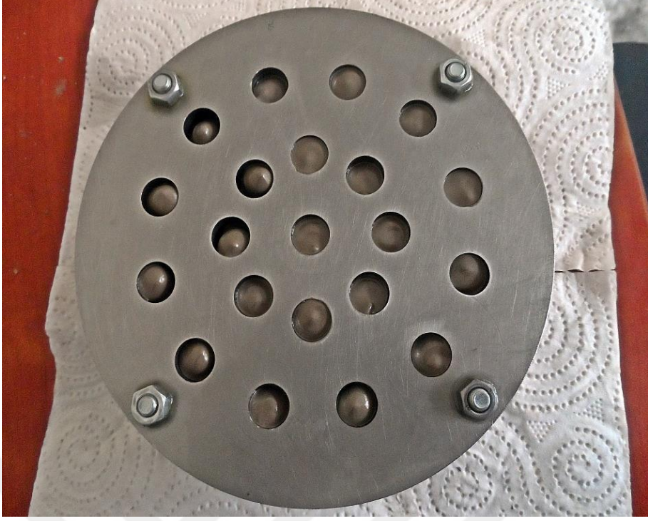
Şekil 5.15. Uçucu kül karışımının kalıbın agrega haznesine eklenmesi
