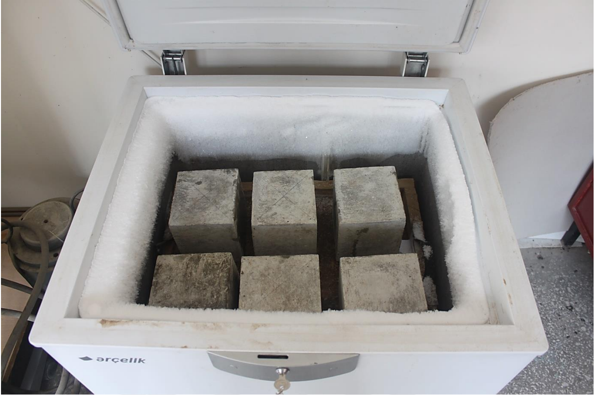
Şekil 6.4. Donma-çözülme deneyine maruz bırakılmış beton numuneler
