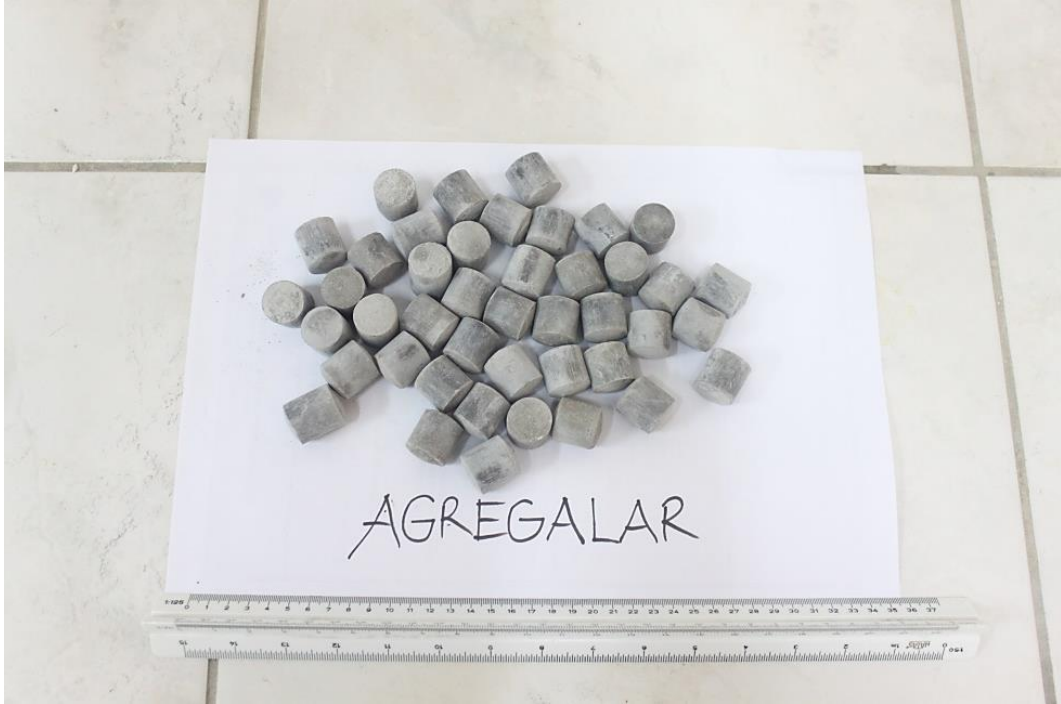
Şekil 5.20. Kalıptan çıkarılmış uçucu külden üretilen 18 mm çapa sahip agregalar
