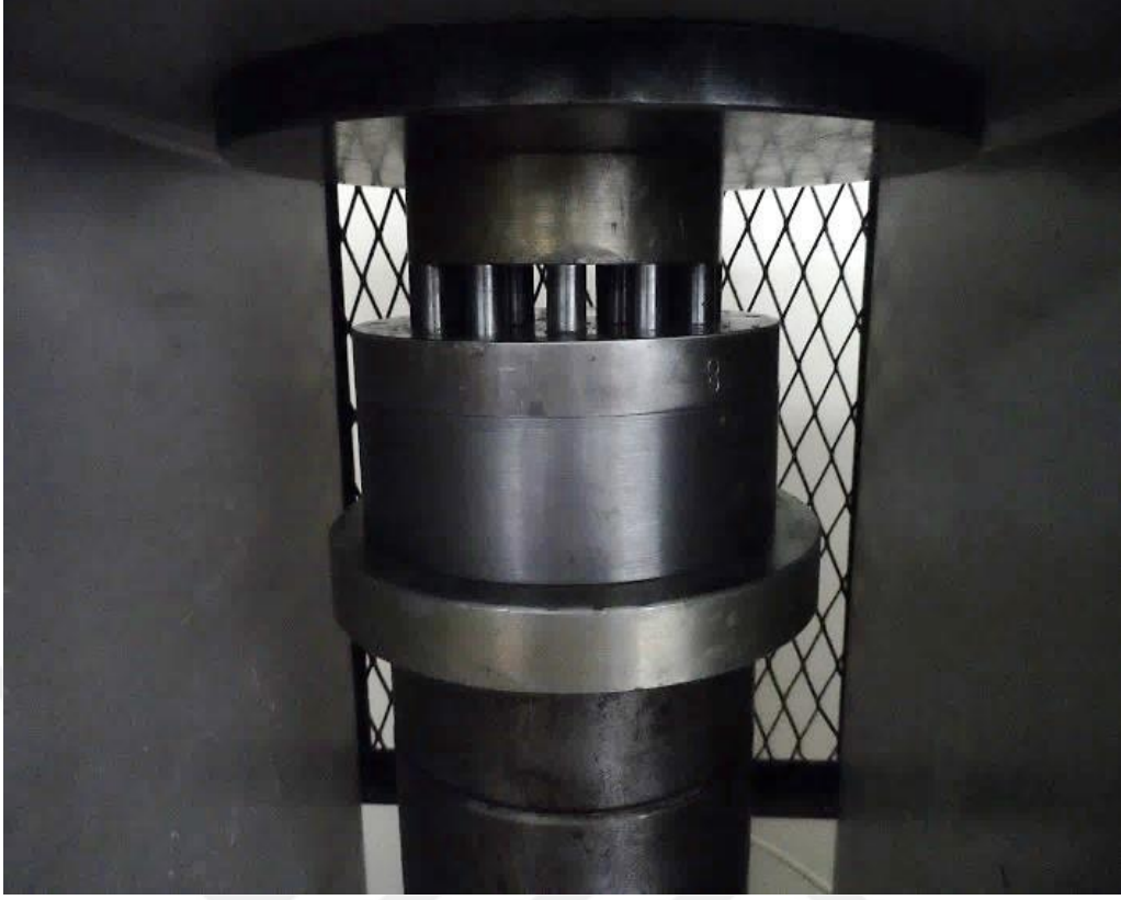
Şekil 5.19. Presleme ile agregaların üst plakadan çıkarılışı
