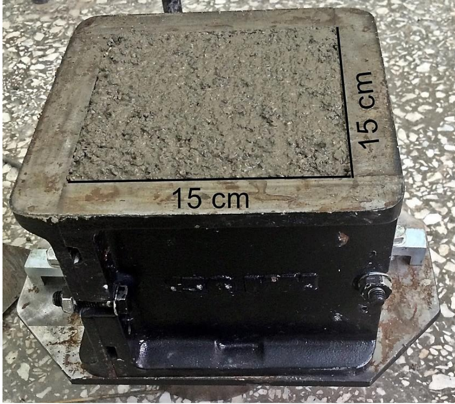
Şekil 6.1. Karışımın beton kalıba dökülmesi
