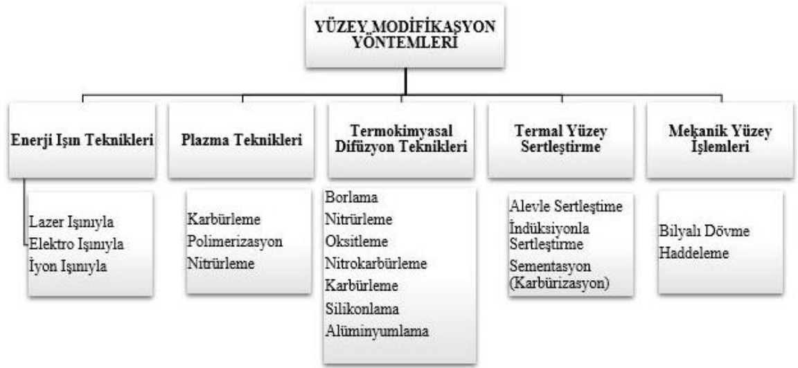
Şekil 2.14. Yüzey modifikasyon işlemlerinin sınıflandırılması (Aslan 2011).
