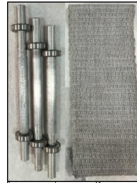
Alüminyum rulo - dar delikli poliüretan bant ve ölçülen değerler
