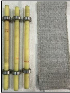
Kestamid rulo - dar delikli poliüretan bant ve ölçülen değerler
