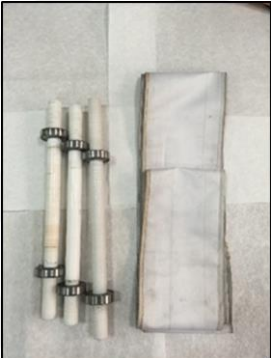
Teflon rulo - naylon bant ve ölçülen değerler
