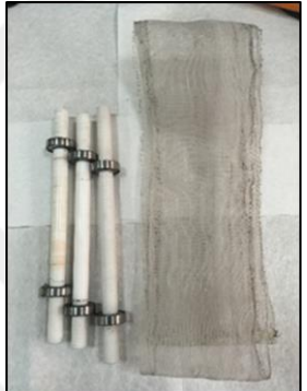
Teflon rulo - naylon/fiber karışımı (delikli) bant ve ölçülen değerler
