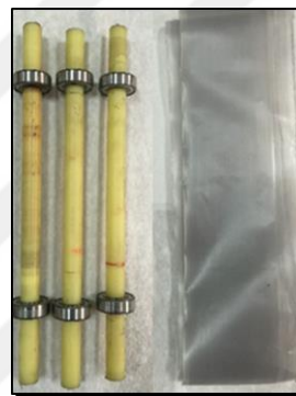
Kestamid rulo - naylon şeffaf bant ve ölçülen değerler
