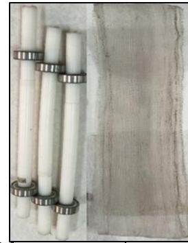
Poliyetilen rulo - naylon/fiber karışımı (delikli) bant ve ölçülen değerler
