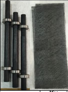
Delrin rulo - fiber bant ve ölçülen değerler
