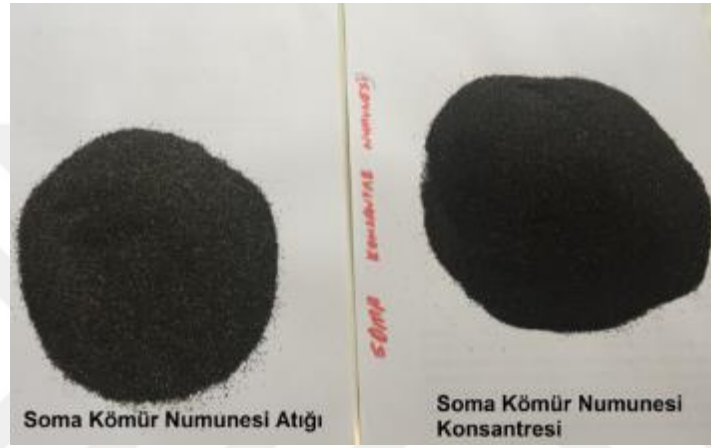
Şekil 5.27. Soma kömür numunesi ayırım sonrası görüntüsü
