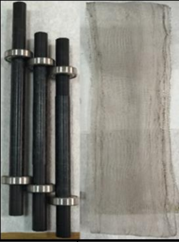
Delrin rulo - naylon/fiber karışımı (delikli) bant ve ölçülen değerler
