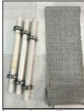
Teflon rulo - dar delikli poliüretan bant ve ölçülen değerler
