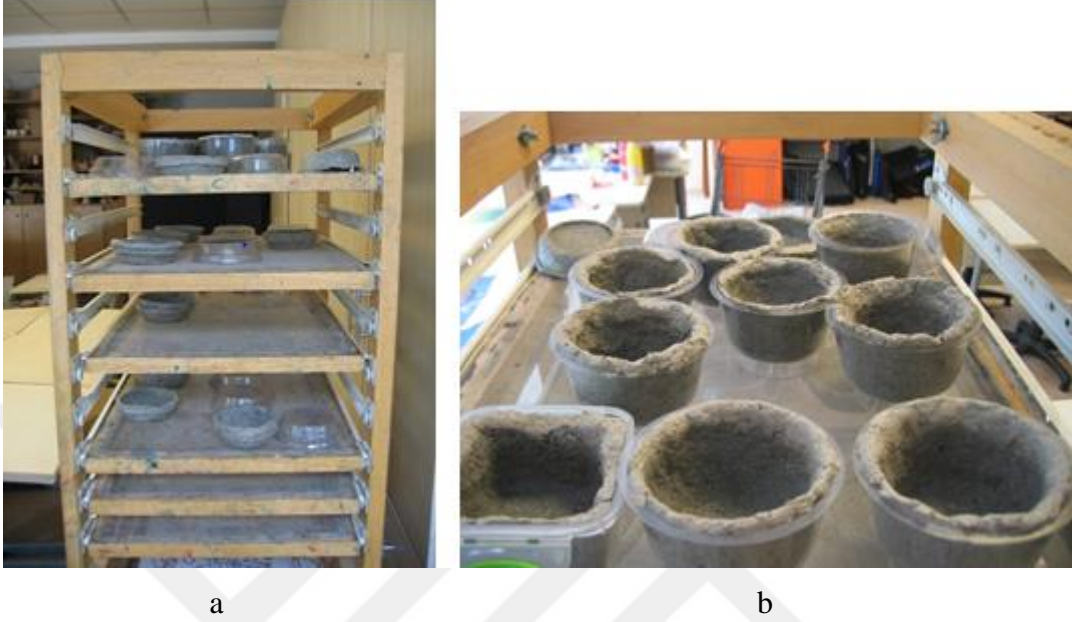
Fotoğraf 4.5. Atık plastik kapların kalıp olarak kullanıldığı, papier maché tekniğinde yapılan kapların kuruma aşaması
