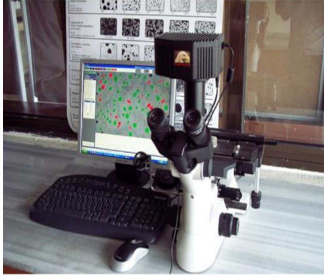
Şekil 4.1. Nikon elipse MA-100 optik mikroskop
