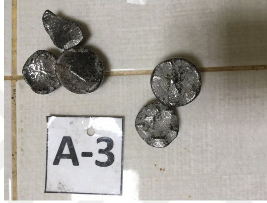
Şekil 5.6. Tamburlama testleri sırasında kırılan öğütücü bilya
