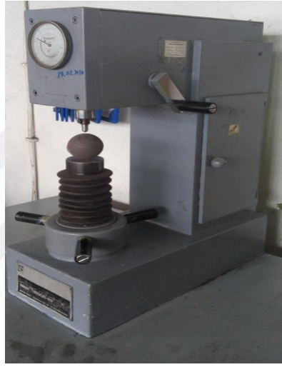
Şekil 4.3. Mergo GmbH Minor-69 sertlik ölçüm cihazı
