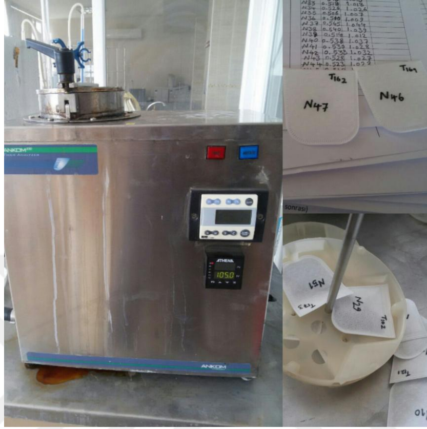
Şekil 3.5. Yem Örneklerinin ADF ve NDF Tayini İçin ANKOM Cihazı
