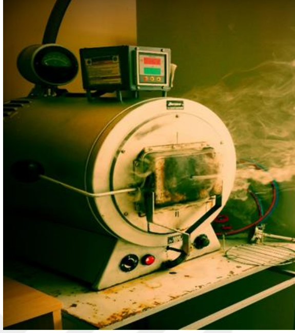
Şekil 3.2. Yem Örneklerinin Kül Fırınında Yakılması
