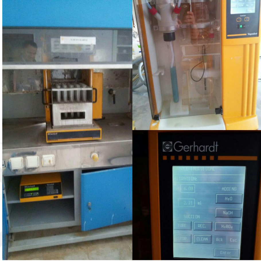
Şekil 3.3. Yem Örneklerinde Ham Protein Analizi
