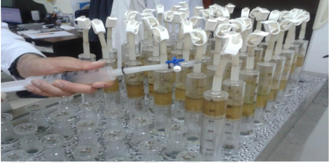
Şekil 3.7. Yem Örneklerinde Gaz Üretimini Belirlemede Kullanılan Sistem
