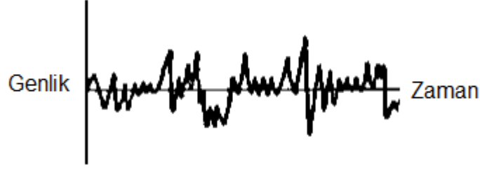
Şekil 10-2 Rastgele titreşimin genlik-zaman grafiği
