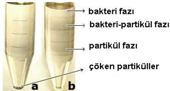
Şekil 75. Floreskamin etiketli a) işlemsiz b) 10 8 kob/ml E.coli K-12 yakalayan Fe 3 O 4 @Au NPlerin 2000 g ile 10 dk santrifüjden sonra faz görünümü
