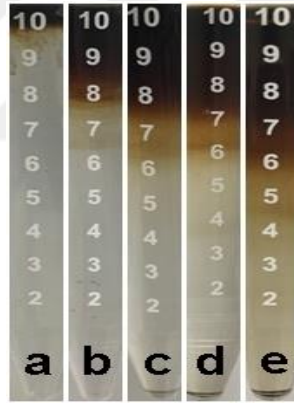
Şekil 54. Fe 3 O 4 nanopartikülün sükroz gradiente 5 dk santirüj ile ilerlemesi a) RCF=0 b) RCF=500 g c) RCF=1500 g d) RCF=3000 g e) RCF=4149 g, t=45 dk
