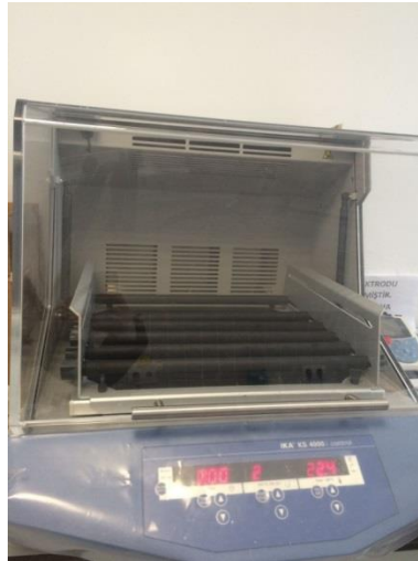
Şekil 3.8 Adsorpsiyon çözeltilerinin hazırlandığı inkübatörlü karıştırıcı sistemi
