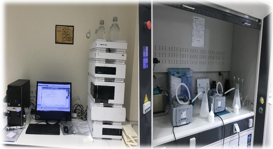
Şekil 3.13. HPLC (Yüksek basınçlı sıvı kromatografi) cihazı ve ekstraksiyon düzeneği
