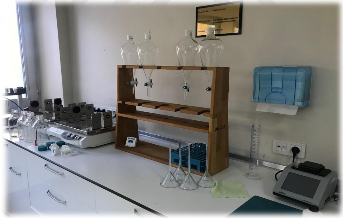
Şekil 3.9. Yağ ve gres tayin cihazı ve düzeneği
