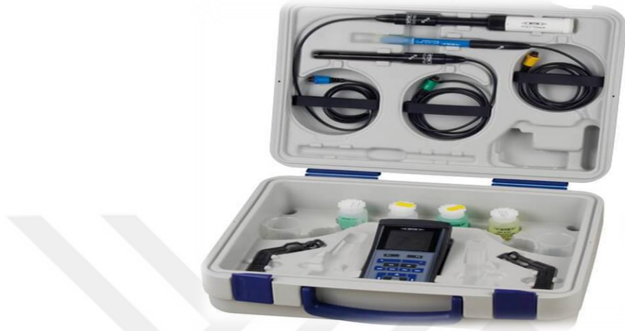
Şekil 3.1. WTW Multi 3420i marka pH, EC, DO ölçüm cihazı
