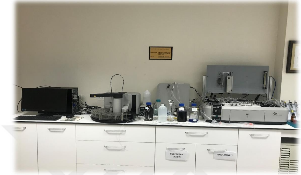
Şekil 3.10. Otoanalizör cihazı (MMAM ve Fenol Tayini Cihazı)
