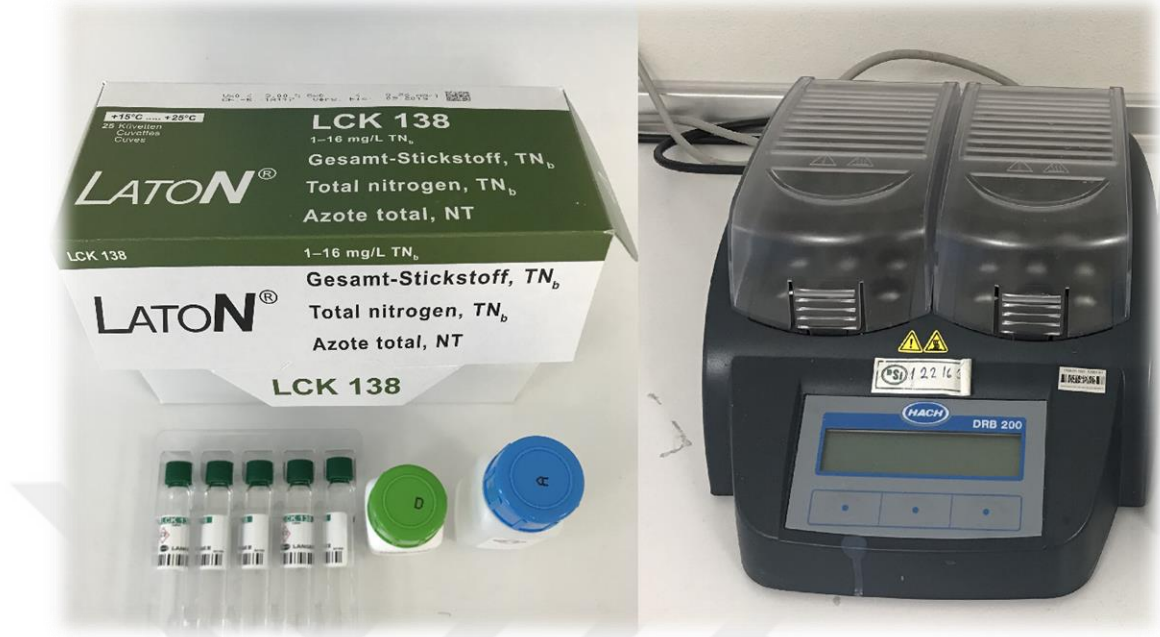
Şekil 3.5. Toplam azot tayini kiti ve termoreaktör
