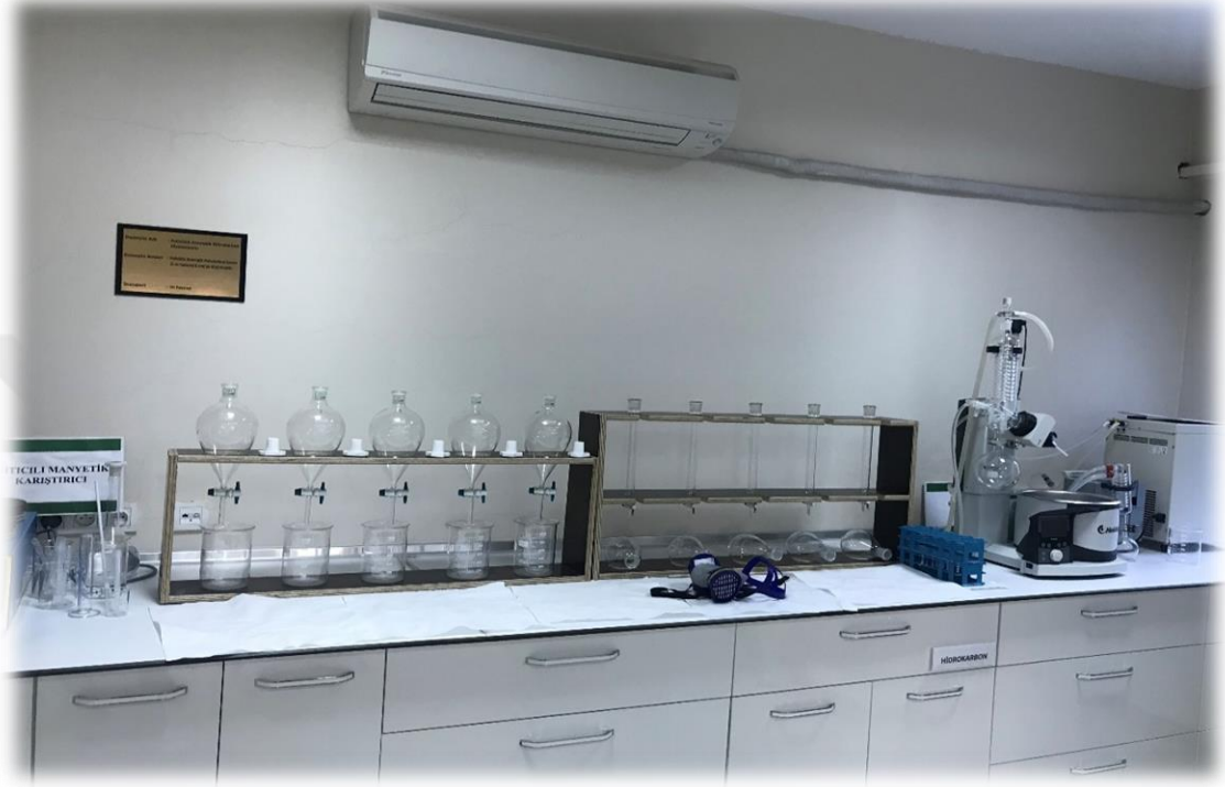
Şekil 3.12. Hidrokarbon ekstraksiyon düzeneği ve Rotary Evaporatör Cihazı
