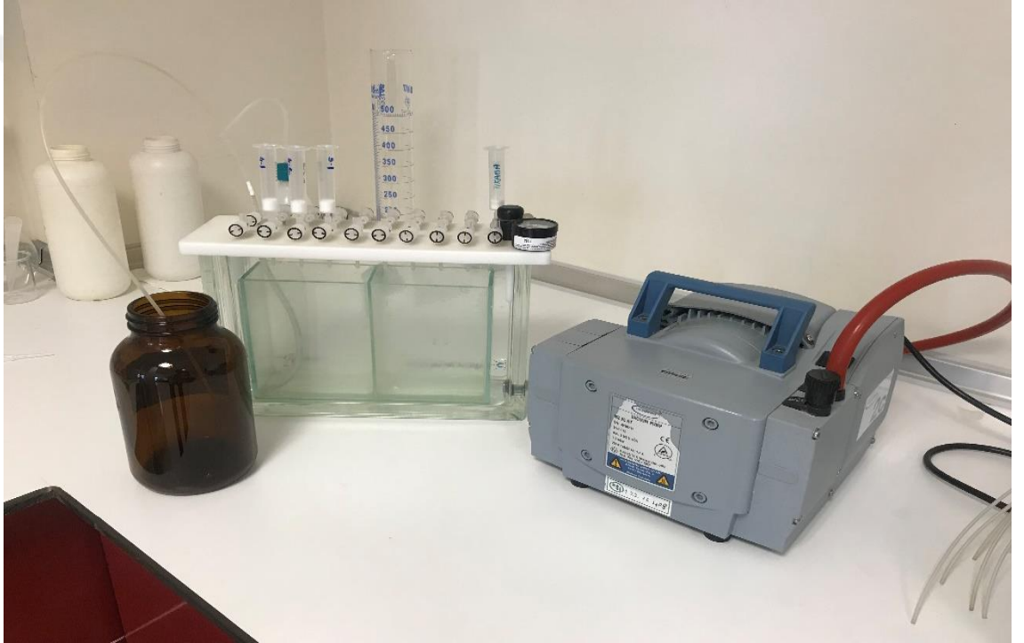
Şekil 3.14. Pestisit ekstraksiyon düzeneği
