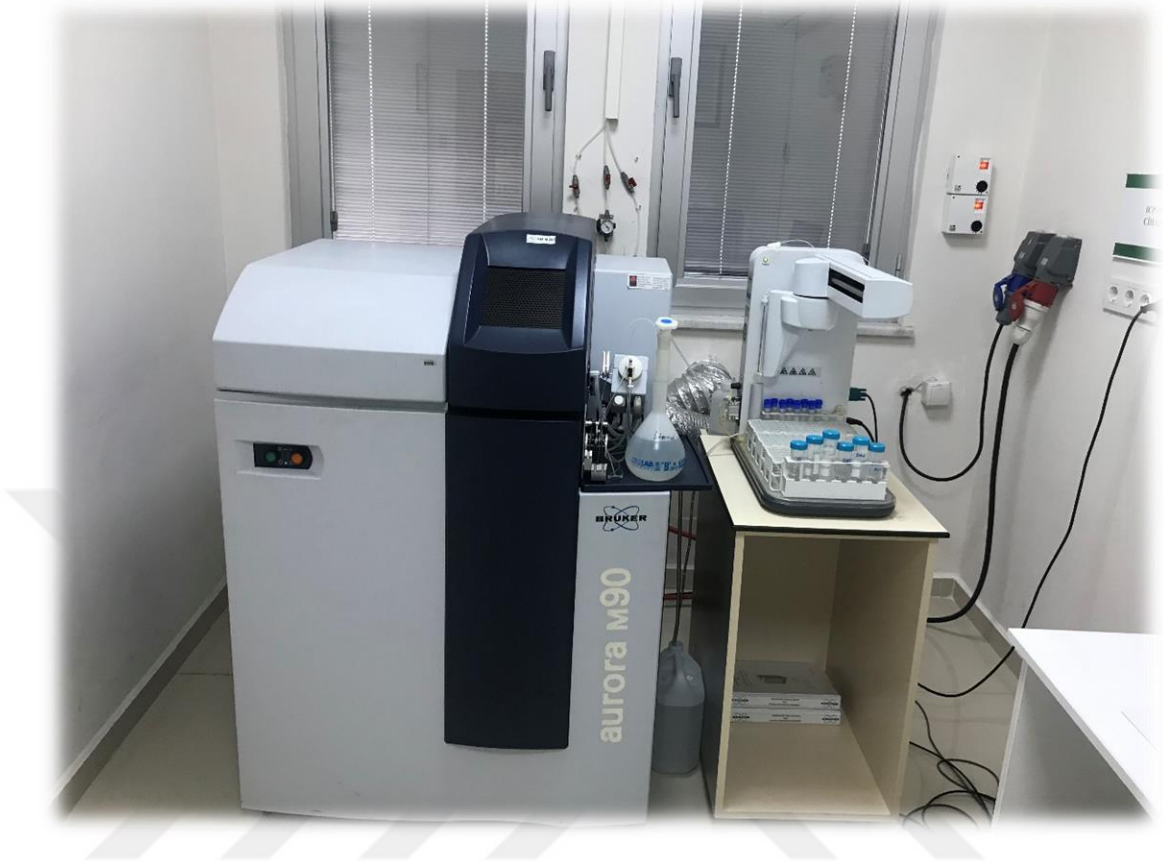
Şekil 3.15. Bruker Aurora M90 ICP-MS cihazı (ağır metal analizi)
