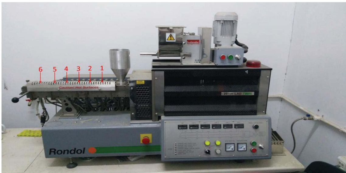
Şekil 3.3. Sürekli sistemde kullanılan çift vidalı ekstrüder
