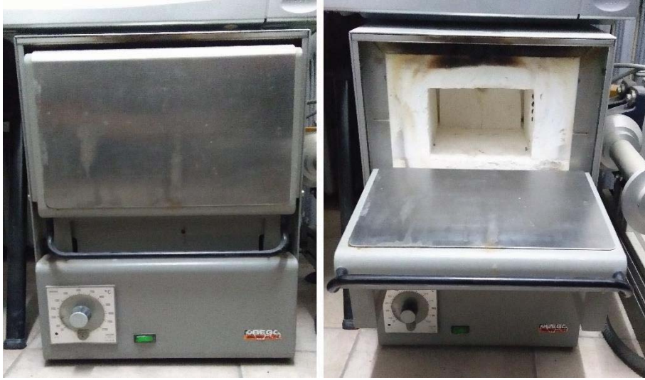
Şekil 3.2. Kesikli sistemde ve masterbatch yönteminde kullanılan fırın
