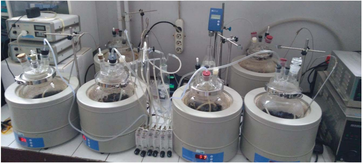
Şekil 3.5. ISO 14855-1:2013 standardında hazırlanan kompostlaştırma deney düzeneği
