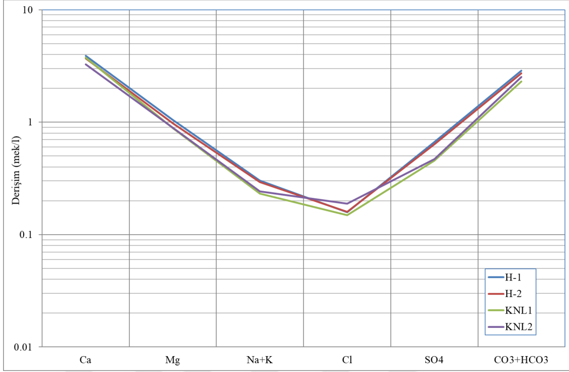
Şekil 5.7. İnceleme alanında yer alan akarsu örneklerine ait kurak dönem Schoeller grafiği (Örnek kodları Çizelge 5.1.'te açıklanmıştır)
