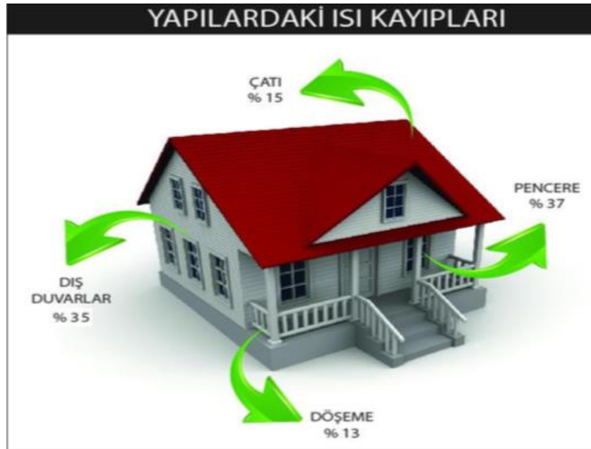
Şekil 2.1. Konutlarda ısı kaybının dağılımı (Baetens, 2010).
