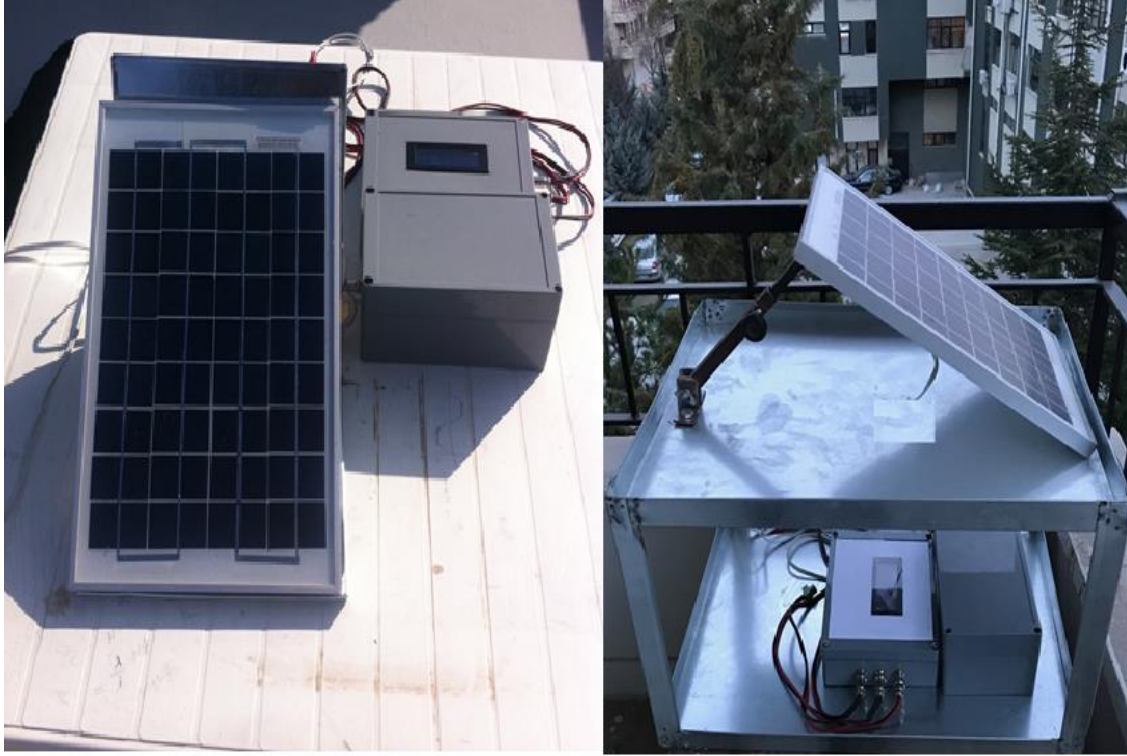
Şekil 7.3: Fotovoltaik kontrol sistemi için tasarlanan yapılar ve test ortamları
