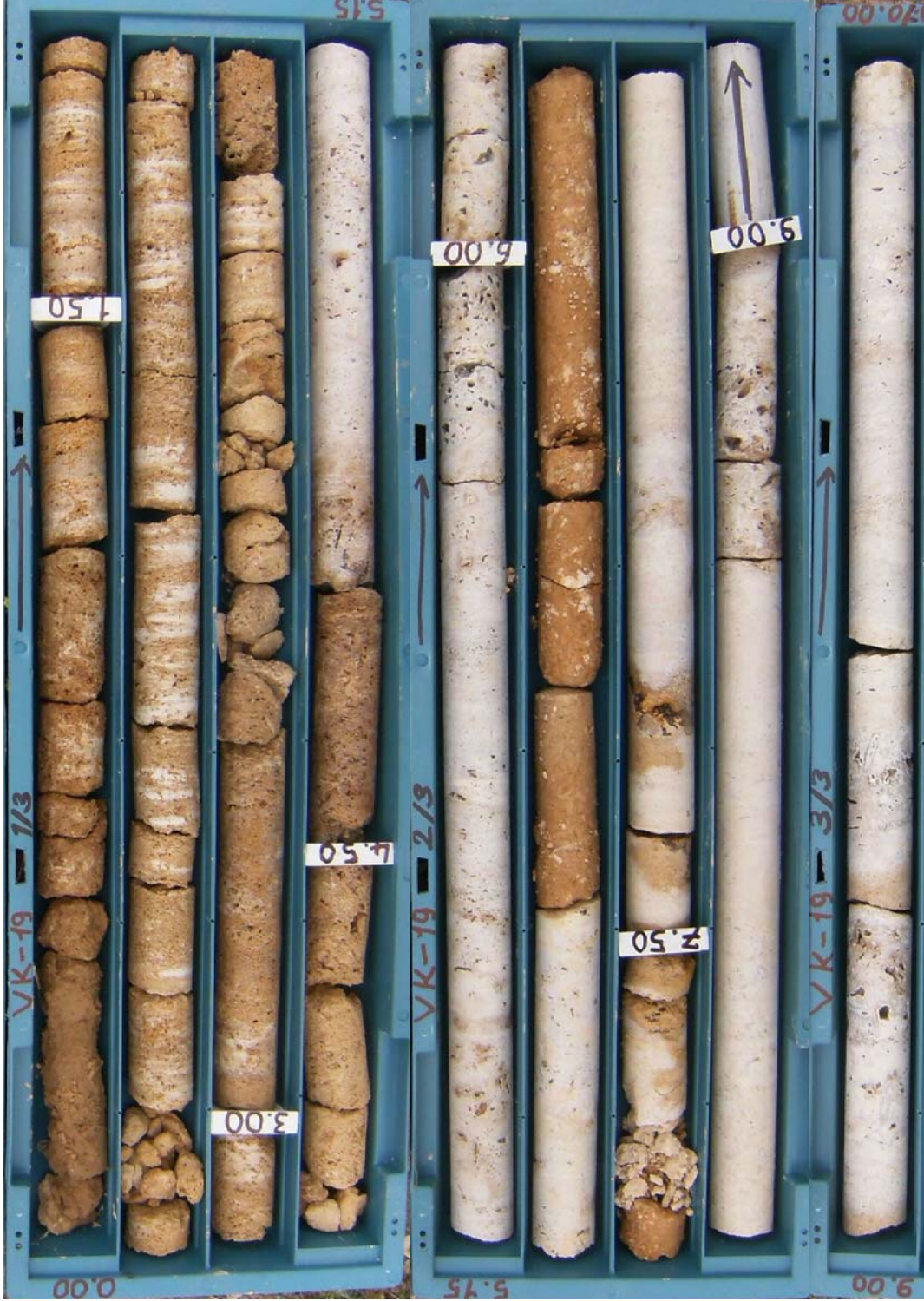
Şekil 3.7. Veri tabanında yer alan bir lokasyona ait örnek karot sandıklarının görüntüsü
