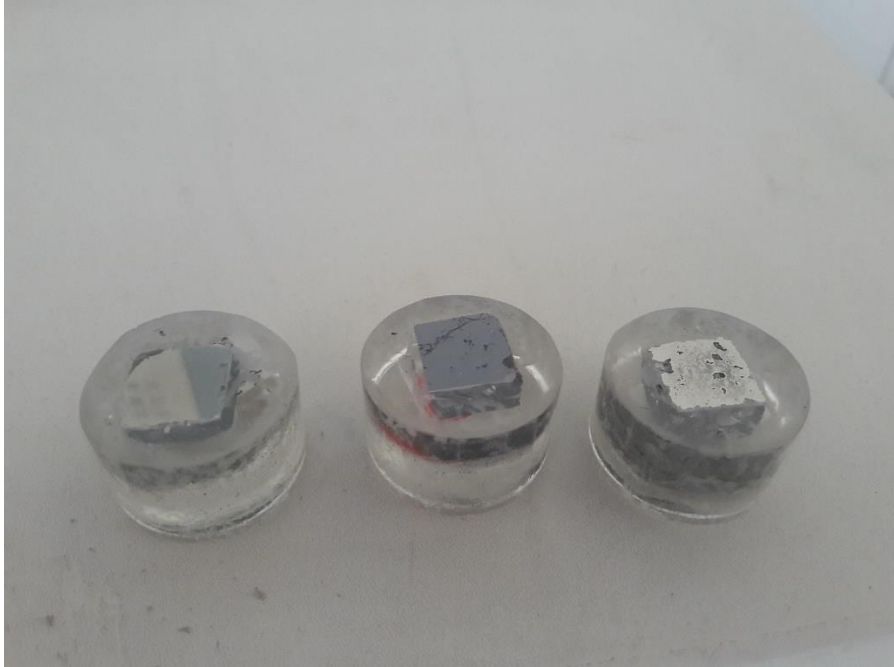
Şekil 3.4. Deneyleerde kullanılan pirit, sfalerit ve kalkopiritin yüzeyleri
