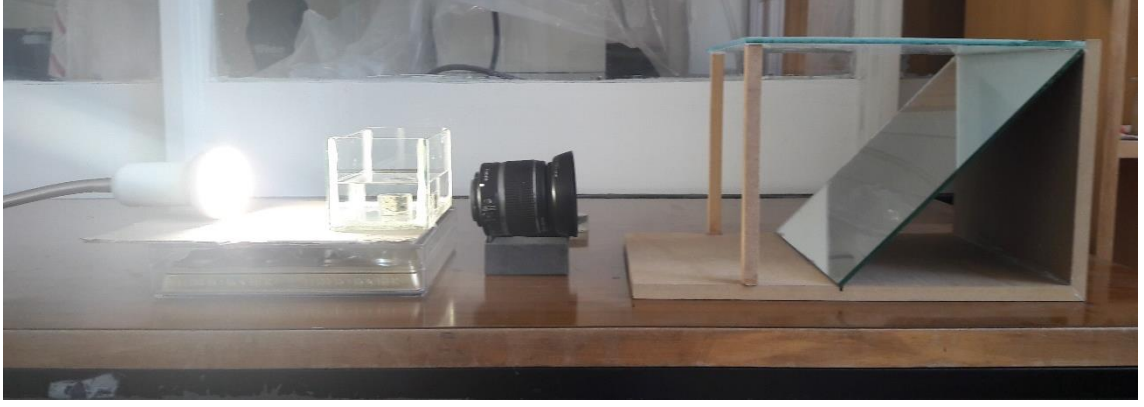
Şekil 3.2. Temas açısı ölçüm düzeneği
