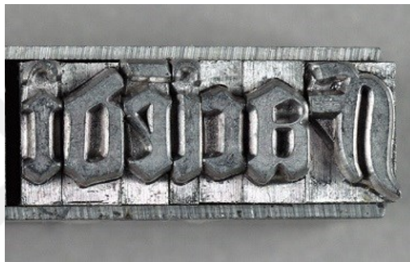
Resim 2.12. Gutenberg'in tip baskı tekniğine göre dizilmiş metal harfler
