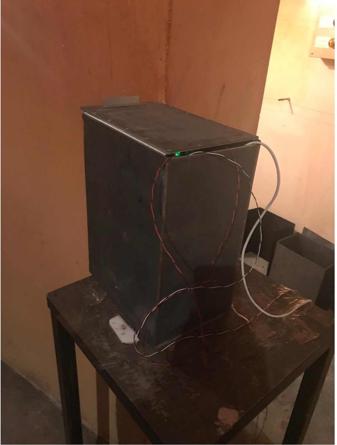
Şekil 5.23. Gama ışımalarının doz ayarı için kullanılan metal kutu düzeneği
