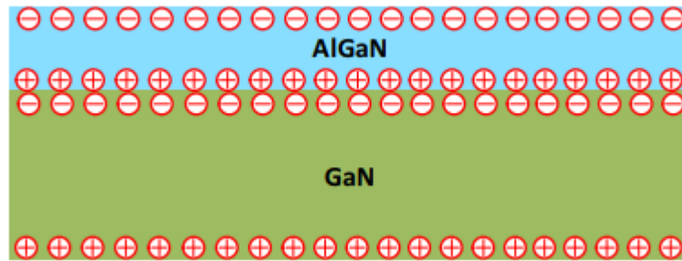
Şekil 3.4. GaN ve AlGaN ortak yüzeyinde 2 boyutlu elektron gaz yapısının oluşumu
