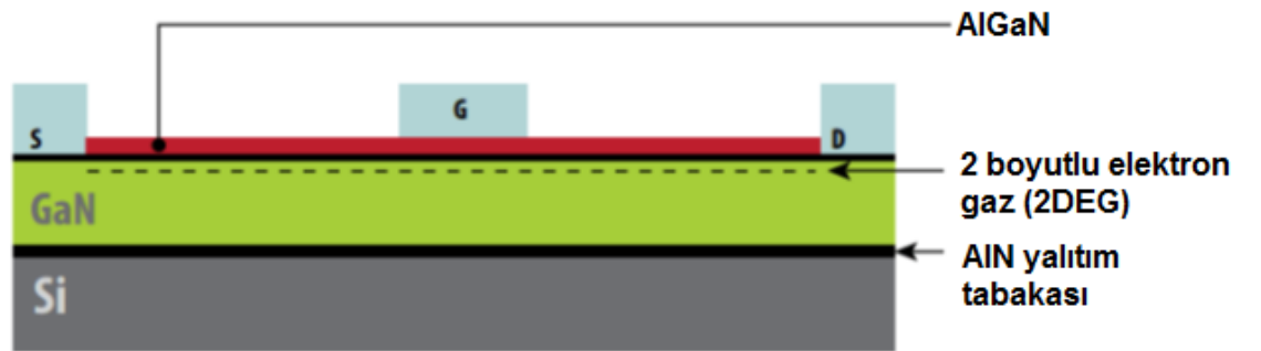
Şekil 3.6. Tükenim modlu GaN tranzistörlerin iç yapısı
