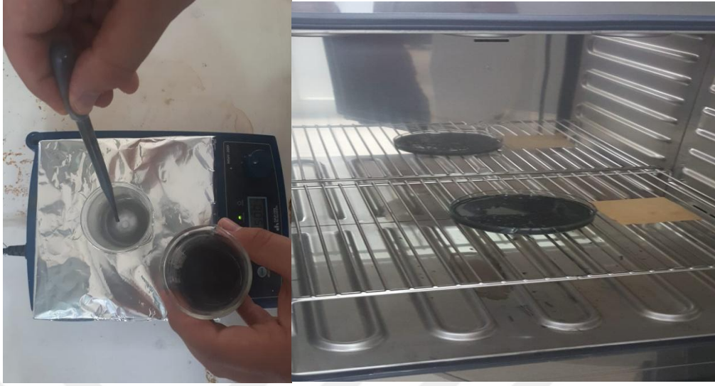
Şekil 3.8. rGO – TiO 2 – PEG sentez aşamaları
