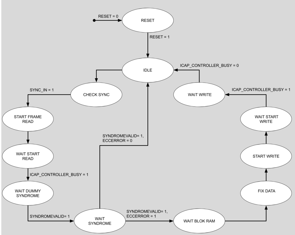
Şekil 4-4 FRAME_ECC kontrol modülü FSM diyagramı
