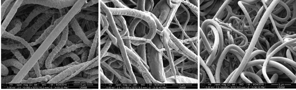
Şekil 4.1. 15 rpm (sol), 22.5 rpm (orta), 30 rpm (sağ) hızda döndürülen koagülasyon banyosu içerisinde, 18 cm mesafede üretilen PCL fiberlerin SEM görüntüleri (x 10000).
