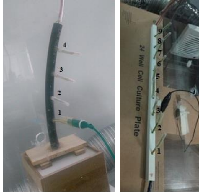
Şekil 3.11. 4 gerilim çıkışı olan voltaj bölücü (sol), 9 gerilim çıkışı olan voltaj bölücü (sağ) fotoğrafları.
