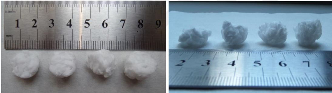
Şekil 4.22. 65:35 çözücü oranındaki çözeltilerden, soldan sağa sırasıyla 25, 20, 15 ve 10 °C R1 banyosuna toplanan 3 dk'lık yumakların üstten (sol) ve yandan (sağ) görünüşleri.
