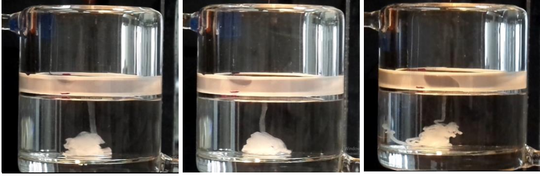
Şekil 4.19. 65:35 çözücü oranındaki PCL çözeltisinden, soldan sağa sırasıyla 10, 9 ve 8 °C R1 banyosuna toplanan örneklerin 3. dk ekran görüntüleri.
