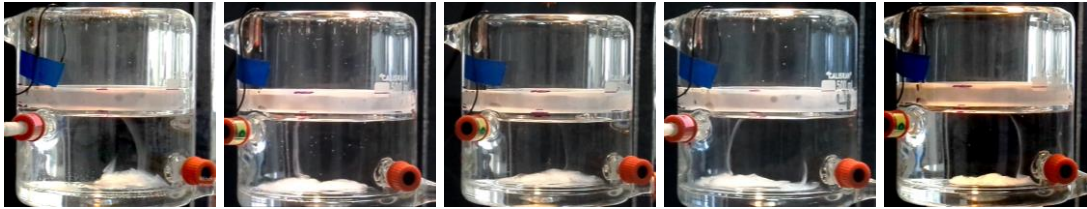
Şekil 4.37. R2'de 25 °C'de soldan sağa sırasıyla 0 rpm, CW 30 rpm, CCW 30 rpm, CCW 60 rpm ve CW 60 rpm elektrik alan döndürme hızlarında 3 dk toplanan örneklerin ekran görüntüleri.
