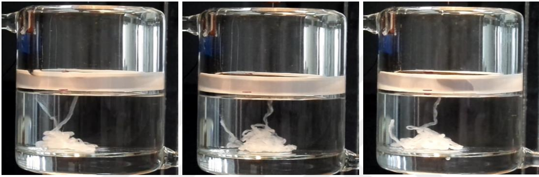
Şekil 4.20. 65:35 çözücü oranındaki PCL çözeltisinden, soldan sağa sırasıyla 7, 6 ve 5 °C R1 banyosuna toplanan örneklerin 3. dk ekran görüntüleri.
