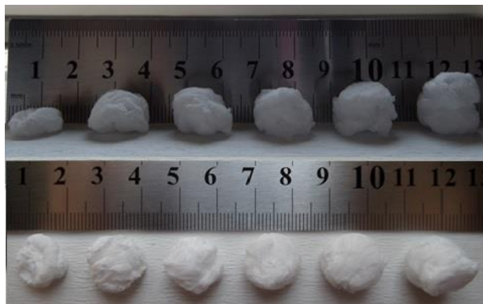
Şekil 4.12. 50:50 çözücü oranındaki PCL çözeltisinden, soldan sağa 25, 15, 10, 9, 8 ve 7 °C R1 banyosuna toplanan yumakların karşıdan ve üstten görünüşleri.
