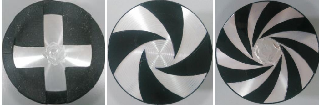
Şekil 3.8. Elektrik alanı yönlendirmek üzere alüminyum disk üzerinde kullanılan desenler; soldan sağa desen1, desen2, desen3.
