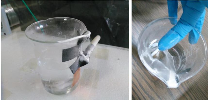
Şekil 3.1. Beher içerisindeki vorteks uygulanan EtOH koagülasyon banyosuna bakır plaka yardımıyla fiber toplama denemesi.
