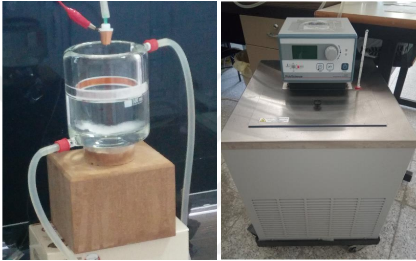
Şekil 3.10. Sıcaklık kontrollü ıslak elektrodeleme düzeneği; sıcaklık kontrollü ceketli cam reaktör (sol), ceket içerisinde belirlenen sıcaklıkta su devridaim eden termal sirkülatör (sağ).
