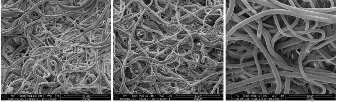
Şekil 4.5. İğne ucunda konik elektrot ile sırasıyla 1 ml/sa, 1.5 ml/sa ve 2 ml/sa akış hızlarında ve 12 cm mesafede üretilen fiberlerin SEM görüntüleri (x 2500).
