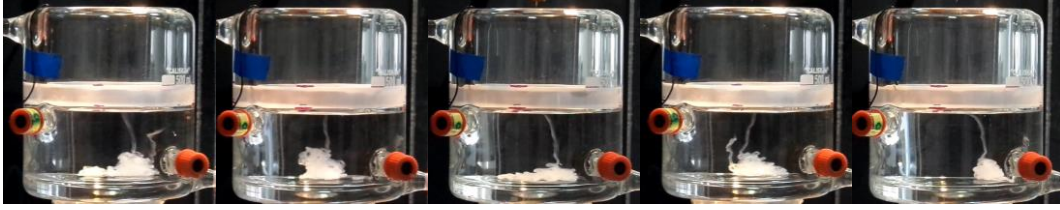
Şekil 4.41. R2'de 10 °C'de soldan sağa sırasıyla 0 rpm, CW 30 rpm, CCW 30 rpm, CCW 60 rpm ve CW 60 rpm elektrik alan döndürme hızlarında 3 dk toplanan örneklerin ekran görüntüleri.
