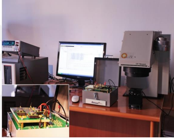
Şekil 3.7. Tel bağlantıları yapılmış elektriksel ölçüme hazır BR-BSSC güneş hücresi ve Güneş Simülatörü
