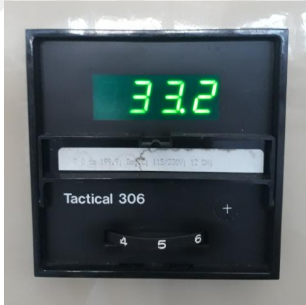
Şekil 3.7. Data logger ile ölçülen sıcaklıkların dijital ekranda okunması
