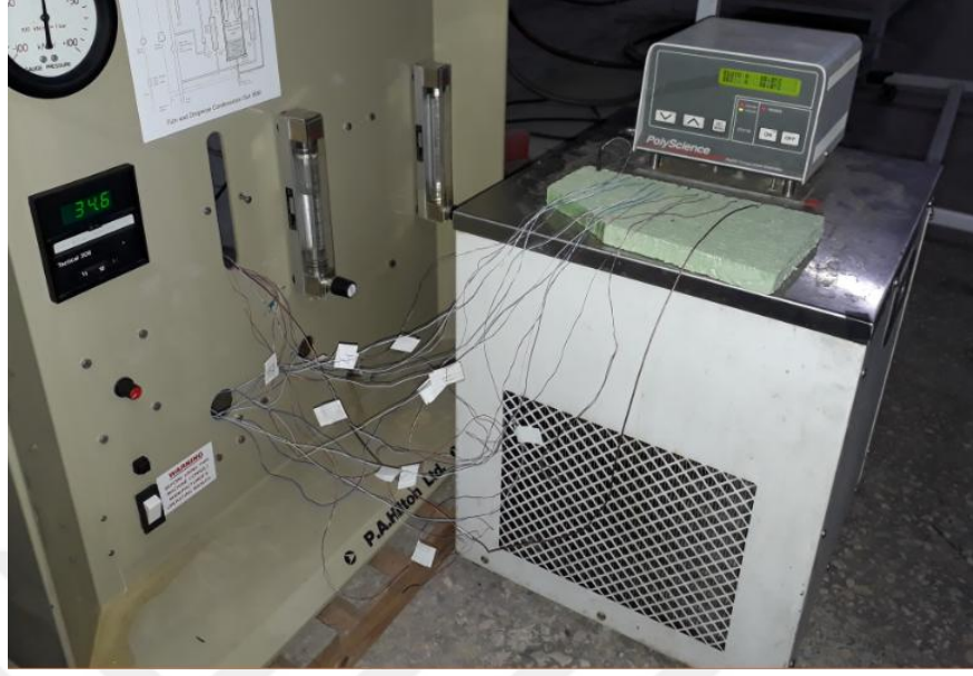
Şekil 3.3. Deneyleer öncesinde termokuplların kalibrasyonunun yapılması
