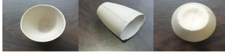
Şekil 3.4. P20K80 (Pomza %20, Kil %80) numunesinin kalıptan çıkarıldıktan sonraki görüntüsü
