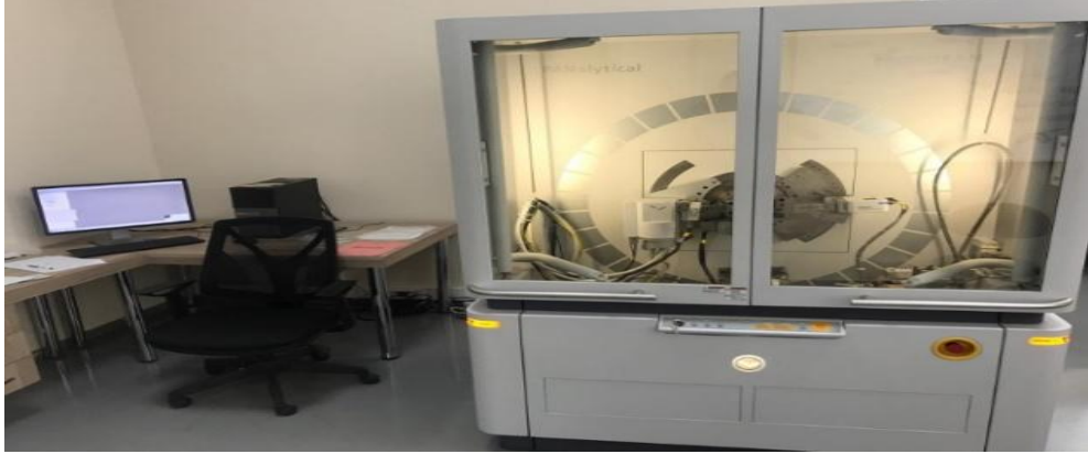
Şekil 3.14. X-Işınları kırınımı cihazı (XRD)
