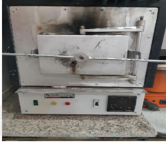
řekil 3.13. Piřirmenin yapıldıđı laboratuvar tipi piřirme fırını
