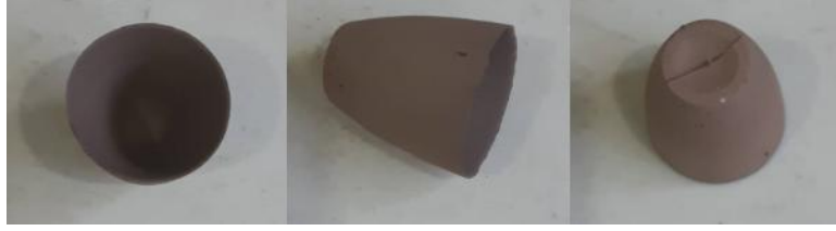
Şekil 3.6. B60K40 (Boksit %60, San-B Kil %40) numunesinin kalıptan çıkarıldıktan sonraki görüntüsü
