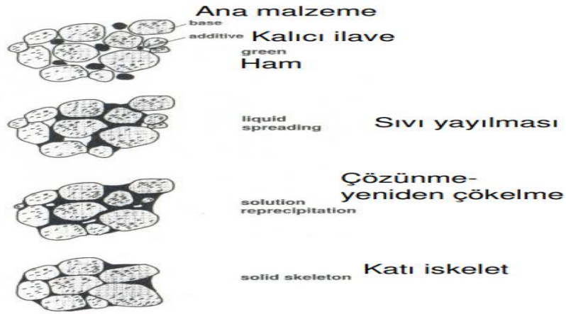
Şekil 2.7. Sıvı faz sinterlemesi aşamaları
