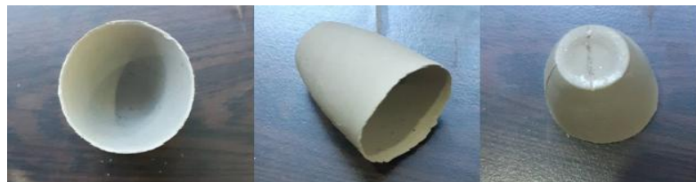
Şekil 3.11. P40C10K50 (Pomza %40, Ferrokrom Cürufu %10, San-B kili %50) numunesinin kalıptan çıkarıldıktan sonraki görüntüsü
