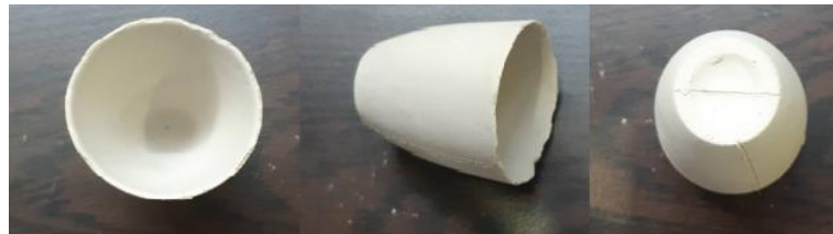
Şekil 3.5. P60K40 (Pomza %60, San-B Kil %40) numunesinin kalıptan çıkarıldıktan sonraki görüntüsü
