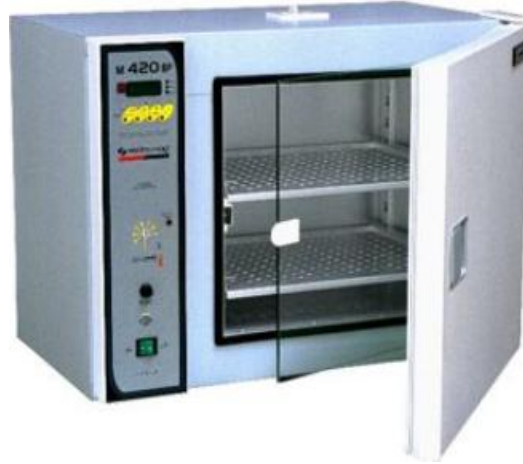
Şekil 3.12. Kurutmanın yapıldığı laboratuvar tipi kurutma cihazı (Etüv)
