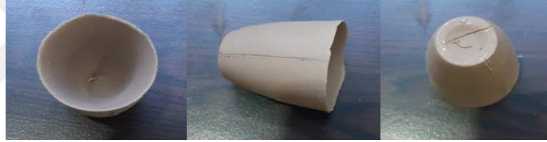
Şekil 3.9. P40B10K50 (Pomza %40, Boksit %10, San-B kili %50) numunesinin kalıptan çıkarıldıktan sonraki görüntüsü
