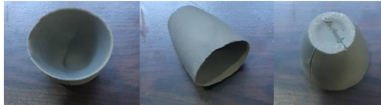
Şekil 3.10. P20C30K50 (Pomza %20, Ferrokrom Cürufu %30, San-B kili %50) numunesinin kalıptan çıkarıldıktan sonraki görüntüsü
