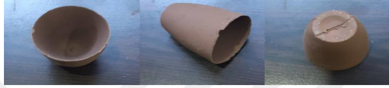
Şekil 3.8. P20B30K50 (Pomza %20, Boksit %30, San-B kili %50) numunesinin kalıptan çıkarıldıktan sonraki görüntüsü
