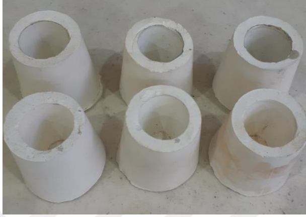
Şekil 3.3. Dökümün yapıldığı alçı kalıp
