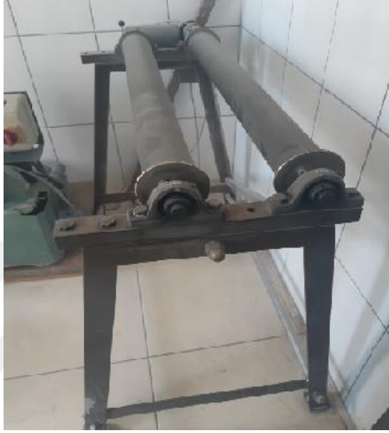
Şekil 3.2. Öğütmenin yapıldığı bilyeli değirmen
