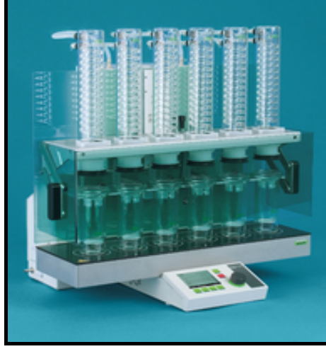
Şekil 6.13 Toplam yağ tayini için kullanılan ekstraksiyon cihazı (BUCHI E 416, Switzerland)
