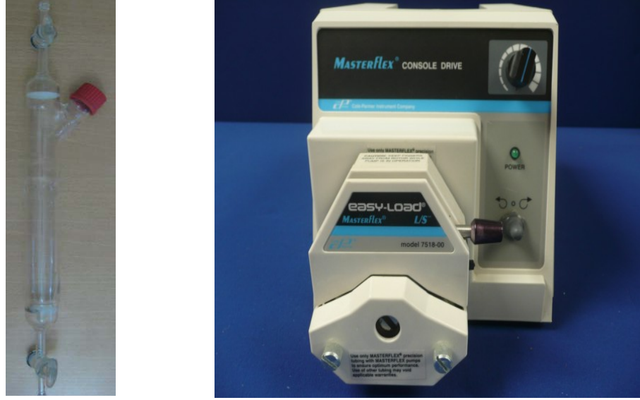
Şekil 3.1 Denemelerde kullanılan cam kolon ve Masterflex Console Driver peristaltik pompa
