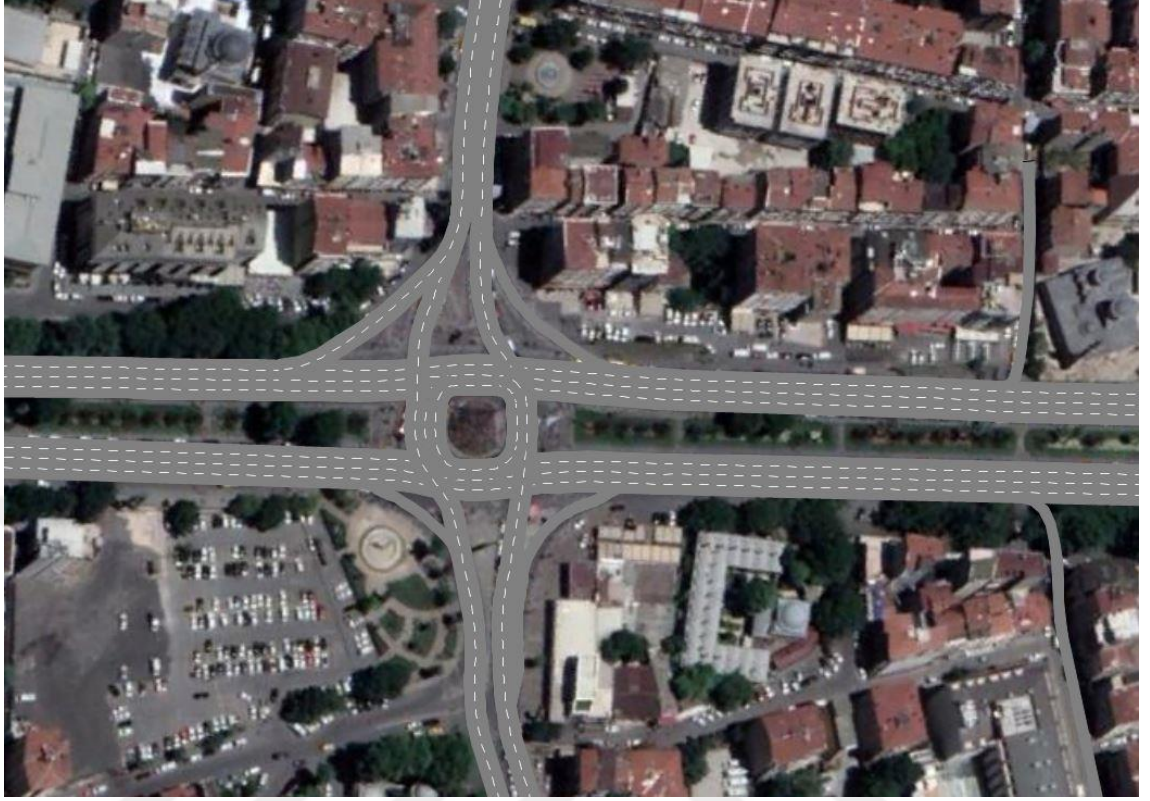
Şekil 4.10. Mevcut durumun 2 Numaralı kavşak yol ağı tasarımı
