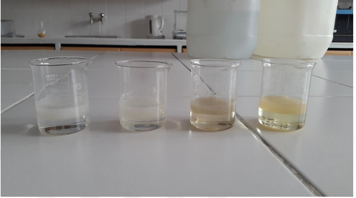
Şekil 4.2. Değişken asit konsantrasyonlarıyla muamele edilmiş STY-DVB polimerik mikroküreler
