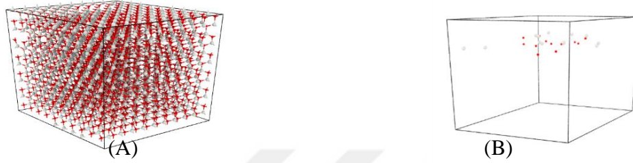
Şekil 4.17. A, Benzetim için hazırlanan ZnO(1-x) numunesi, B, Oksijen ve Zn için boşlukların konumu (oksijen boşlukları kırmızı, çinko boşlukları beyaz renkte gösterilmiştir)
