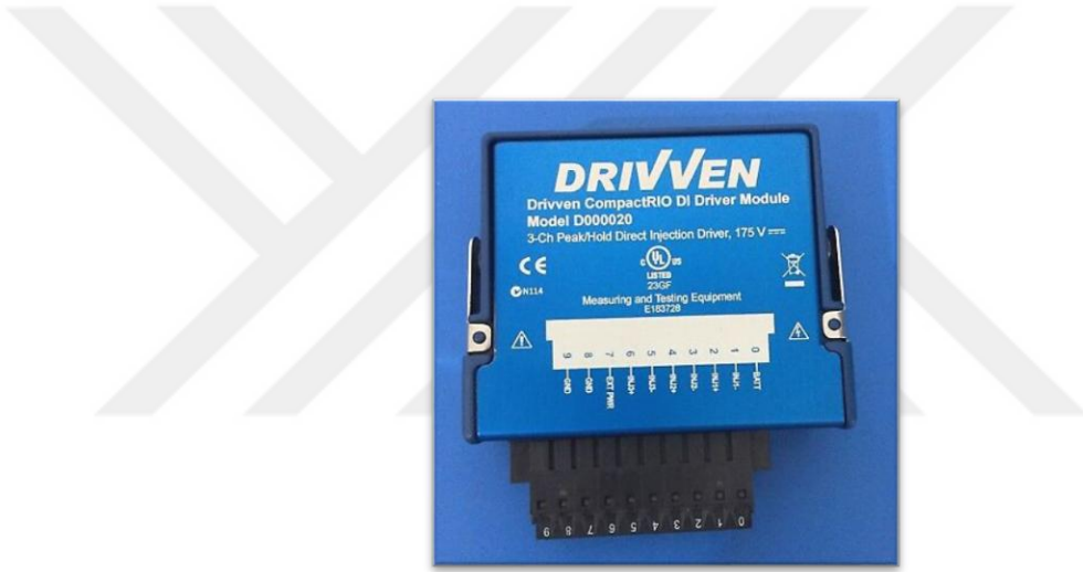
Şekil 3.4. Enjektör sürücü modülü
