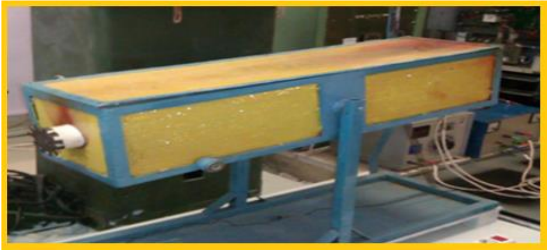
Şekil 3.7. GaS yarıiletkenin büyütüleceği fırınının fotoğrafı (Gürbulak 1997).
