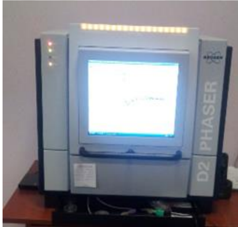
Şekil 2.9. XRD ölçüm cihazı (Bruker D2 Phaser).
