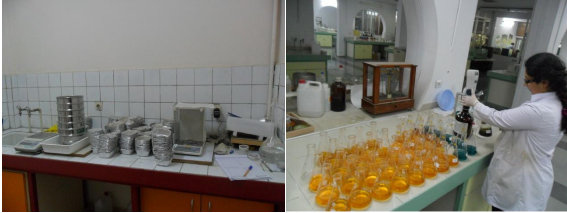
Şekil 3.14 Agregat büyüklük dağılımı ve OK kapsamalarının belirlenmesi
