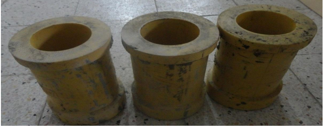
Şekil 3.7. 10x20 cm'lik silindirik kalıplar
