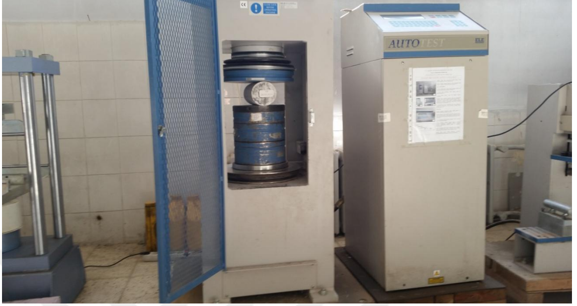
Şekil 3.13. Yarmada çekme dayanımı deney düzeneği
