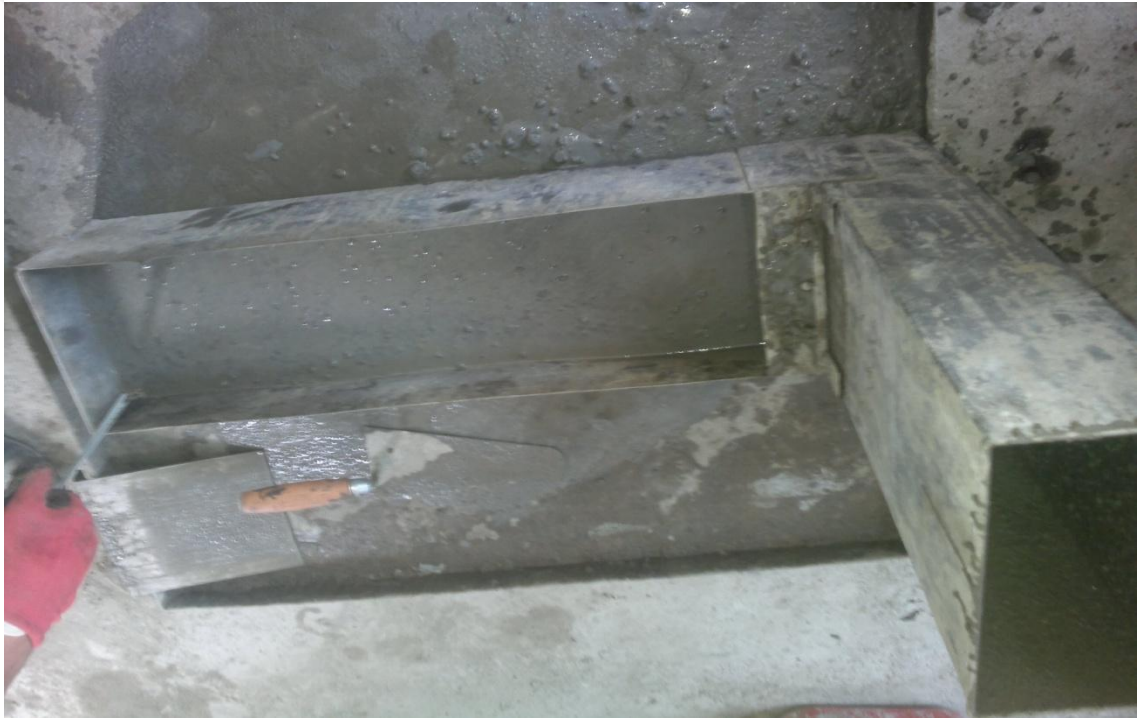
Şekil 4.3. Kontrol betonunun L kutusu görünüşü
