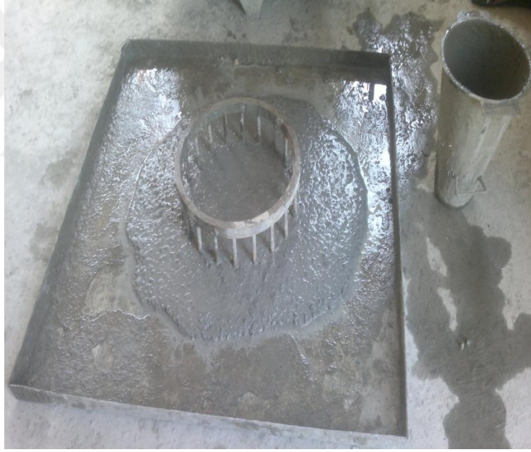
Şekil 4.4. Kontrol betonunun J Halkası görünüşü
