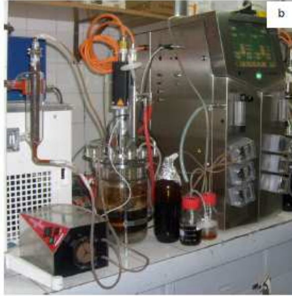
Şekil 3.2. a.Zeytin çekirdeğine tutuklanmış R. glutinis ile biyoarıtımın incelendiği kolon sistemi şematik gösterimi, b. Tutuklanmış R. glutinis ile biyoarıtımın incelendiği kolon sistemi fotoğrafı
