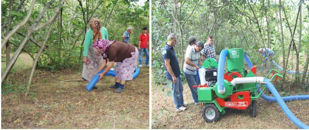
Şekil 1.9. Sarsıcılarla düşürülen fındıkların yerden makine ile toplanması
