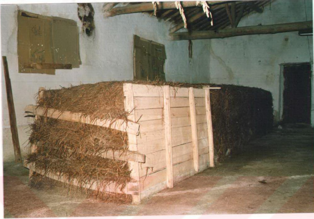
Şekil 2.3. Katkı maddeleri karıştırılmış buğday saplarının kalıp arasında sıkıştırılması.
