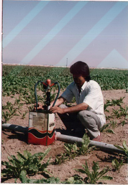
Şekil 3.7. Şebeke başlık debilerini ölçme düzeni
