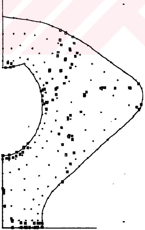
Şekil 7.10b. Teorik yolla elde edilen izoklinik saçaklar ( 15^\circ )
