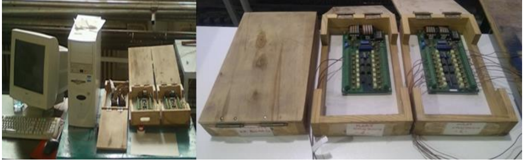
Şekil 3.5. Veri toplama ünitesinin görünüşü
